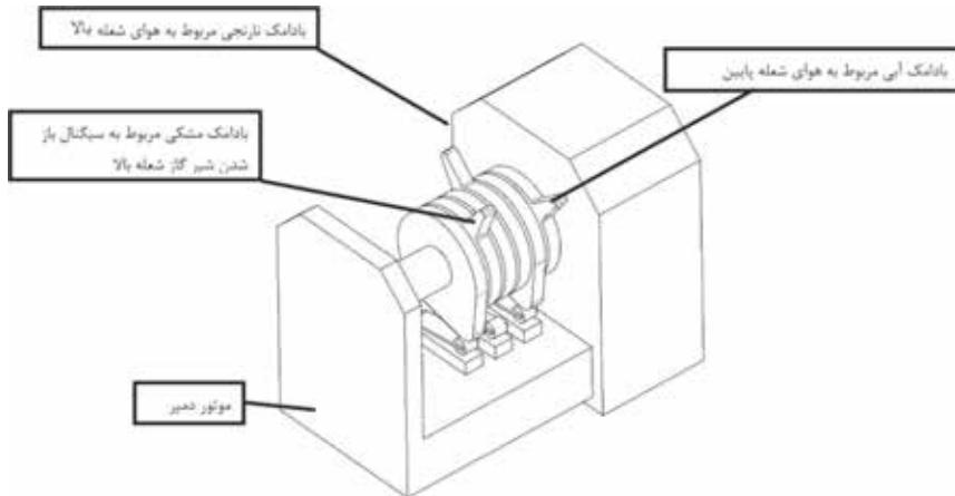
این مشغل بایستی در هر دو حالت شعله بالا و شعله پایین از نظر میزان هوا و راندمان احتراق تنظیم گردد مطابق شکل فوق که بادامکهای موتور دمپیر را نشان میدهد بادامک آبی مربوط به شعله پایین، نارنجی مربوط به شعله بالا و مشکی مربوط به سیگنال باز شدن شیر گاز دوم می باشد. با چرخاندن دستی بادامک ها در جهت عقربه های ساعت میزان هوا کم شده و خلاف عقربه های ساعت هوا زیاد می شود به این نکته دقت کنید که بادامک مشکی همواره بایستی بین بادامک آبی و نارنجی قرار گیرد.
