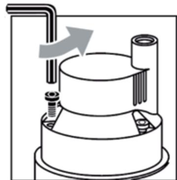
تنظیم سرعت باز شدن شیر با حداکثر ۳ دور قابل تنظیم است با چرخاندن آن در خلاف عقربه های ساعت سرعت باز شدن افزایش می یابد.
