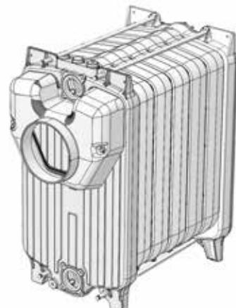
۱۵- لوله آب پخش کن و فلنج های وصل لوله را در محل پره عقب موتیاز نمایید . به منظور موتیاز لوله آب پخش کن دقیق نمایید که شیار روی فلنج لوله آب پخش کن حتما رو به بالا قرار گیرد
