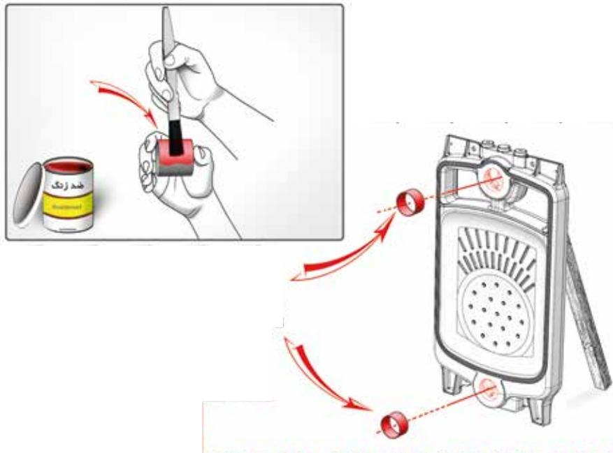
تذکر : توجه فرمائید در صورتیکه بوش ها درست جا نیفتند و یا کج در محل قرار گیرند هنگام موتتاژ ایجاد مشکل می کنند و سبب پیدا شدن درز و نشت آب از دیگ می شوند . برای اطمینان از آب بندی بوش ها می توانید وسط بوش را ضد زنگ و چند لایه نوار تلفون بیندید که کاملاً درز بوش و نافی پره آب بندی گردد . دقت فرمائید بوش مربوط به دیگ تهیه گردد . بوش های متفرقه بدليل زاويه اشتباه در مقایسه با زاويه نافی دیگ سطح تماس کافی آبندی نداشته و ایجاد نشتی و مشکلات زیادی برای دیگ می نماید .
