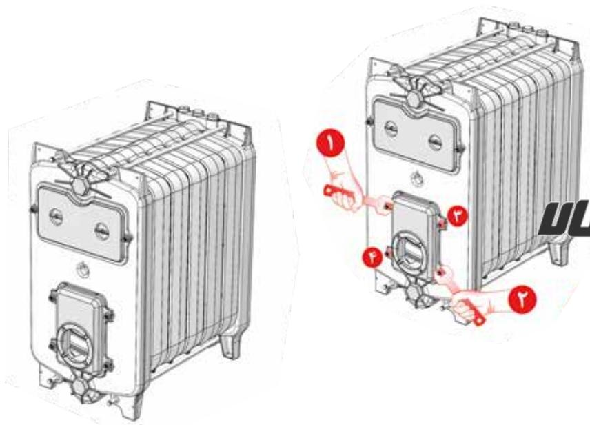
۱۴ - به منظور مونتاژ دودکش روی پره عقب نخ نسوز را روی پره عقب در محل مربوطه قرار داده و محکم نمایید . سپس دودکش را در محل مربوطه روی پره عقب مونتاژ کنید .
